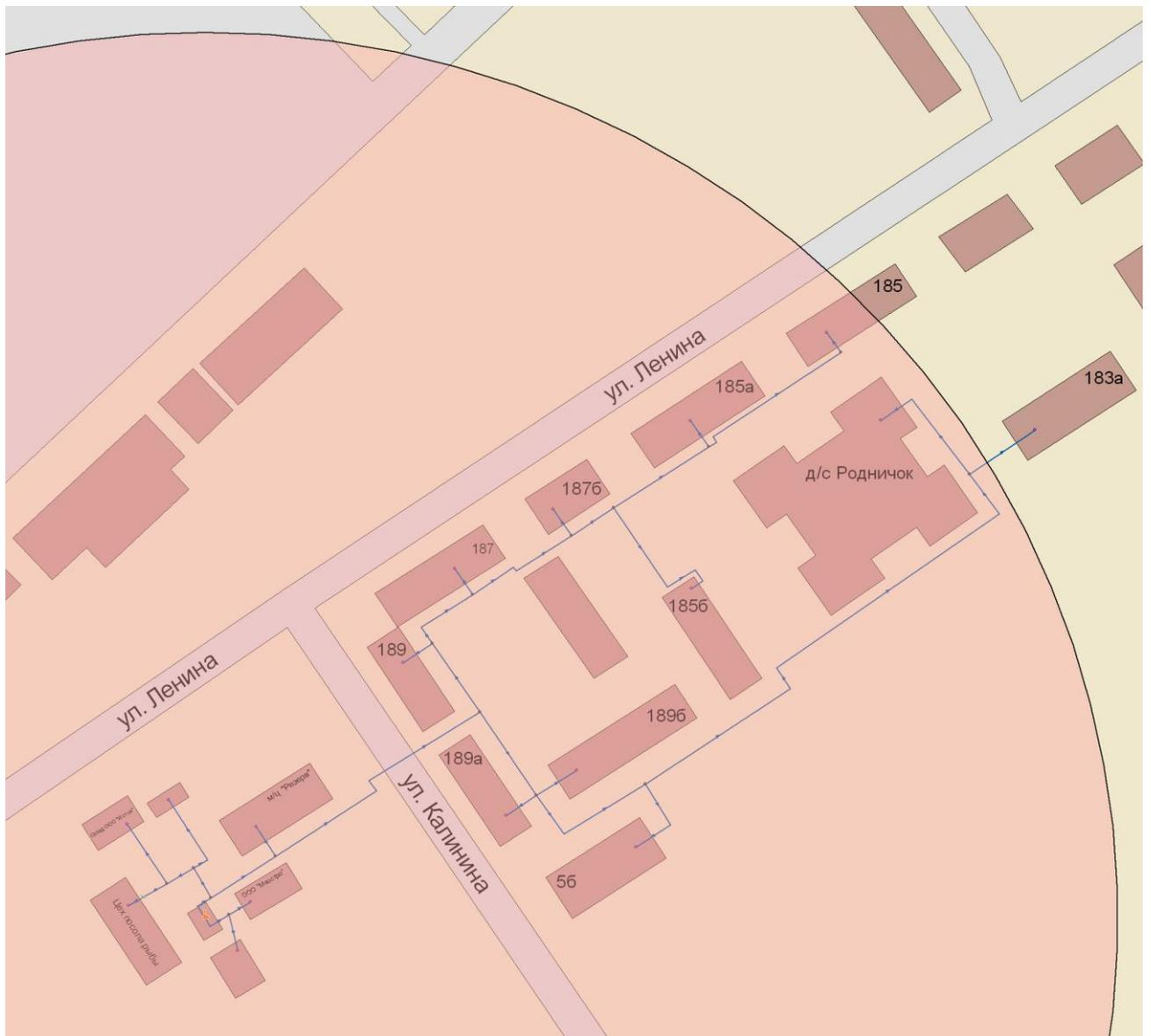
**Рисунок 12. Радиус эффективного теплоснабжения от здания котельной ул. Ленина, 1766/1 (Водник)**
