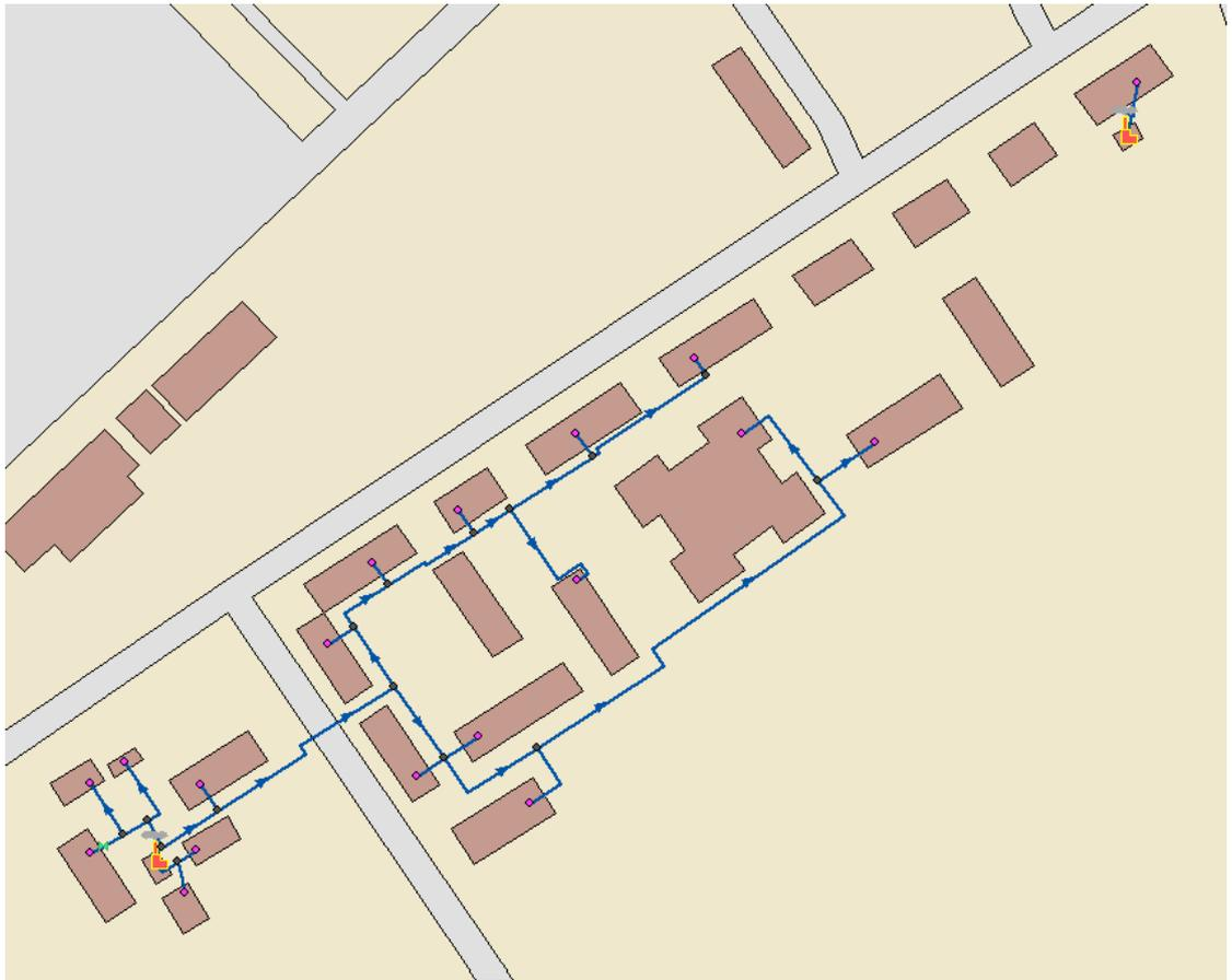
**Рисунок 25. Схема тепловых сетей от здания котельной ул. Ленина, 1766/1 (Водник) и мини-котельной ул. Ленина, дом №1776**
