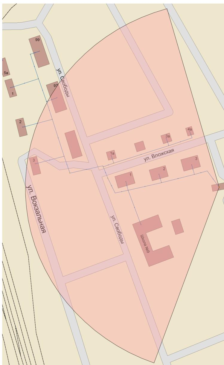
**Рисунок 6. Радиус эффективного теплоснабжения от здания котельной ул. Волжская, дом №4**
