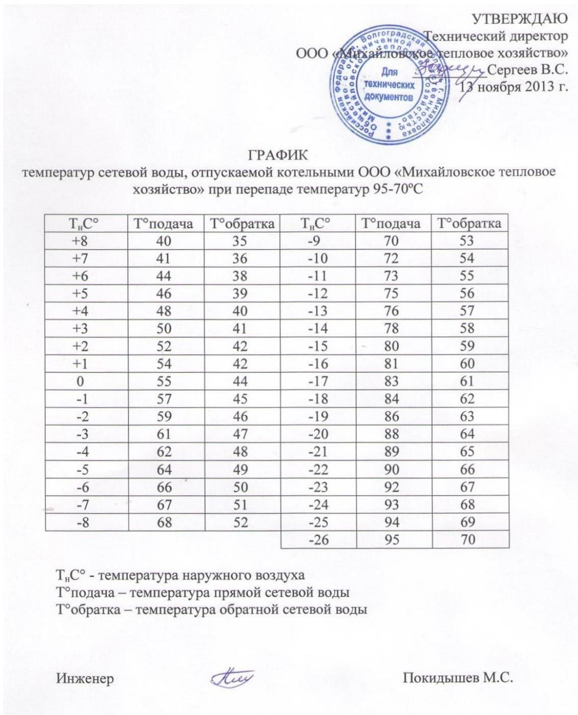
**Рисунок 21. Температурный график сетевой воды, отпускаемой котельными**
