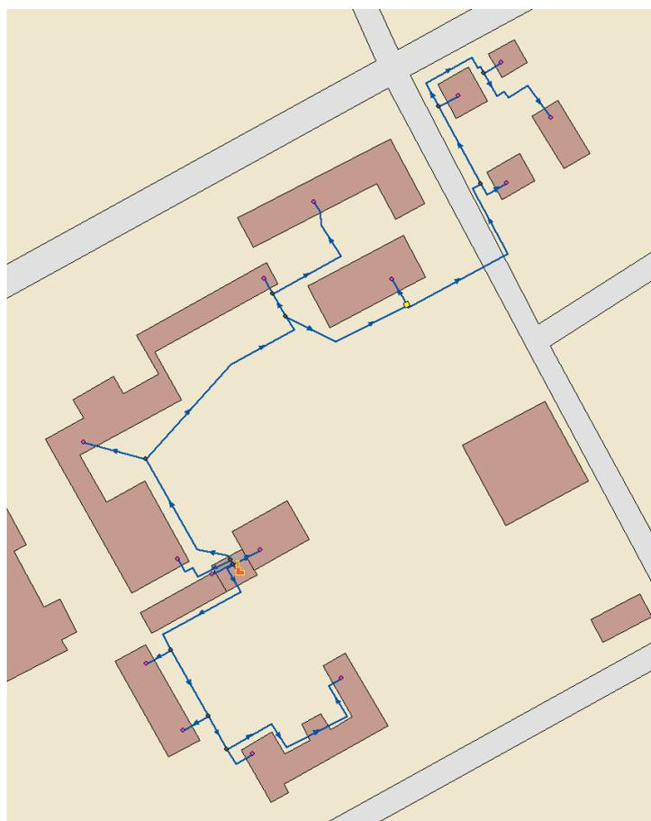
**Рисунок 34. Схема тепловых сетей от котельной ул. Гоголя, дом №29/1 (Педколледж)**
